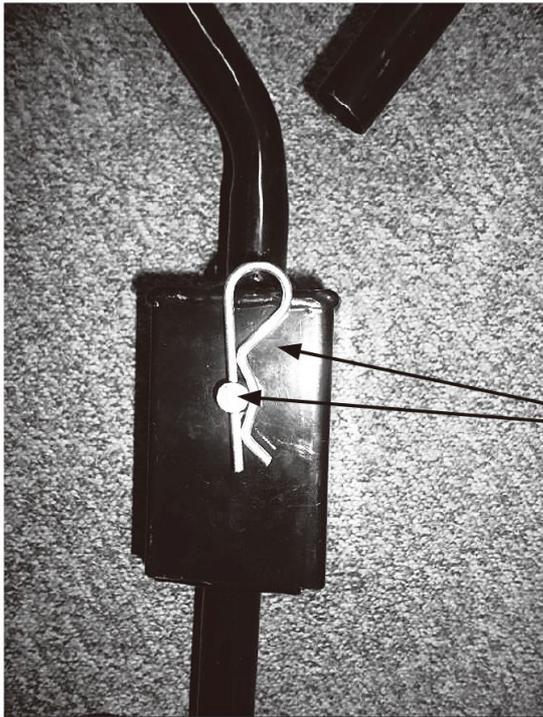
b) Falls Sie den Gartenwagen als Anhänger für einen Gartentraktor verwenden möchten, nehmen Sie den Zuggriff (14) ab, indem Sie Schraube und Federstecker lösen. Dann können Sie die Anhängerkupplung des Gartentraktors auf die gleiche Weise mit der Zuggriff-Stange verbinden.
