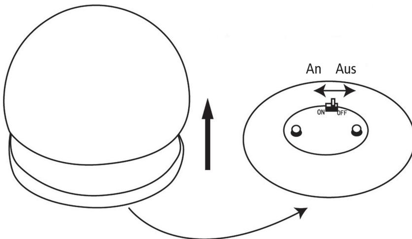
Das Licht geht bei Dämmerung von alleine an. Mit dem Schalter oben rechts kann man die Lampe ganz abschalten.
