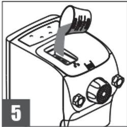
Stecken Sie den Netzstecker in eine Netzsteckdose. Drücken Sie die An/Aus-Taste. Drücken Sie die gewünschte Automatik-Taste (1, 2 oder 3) gemäß der eingefüllten Mehlmenge. Wenn sich die Mischwelle dreht, schütten Sie die korrekte Menge Wasser/Eier in die Tropföffnung des Deckels. Achten Sie darauf, dass Sie das korrekte Mischverhältnis von Wasser und Mehl einhalten, wie in der Tabelle von Seite 9 angegeben.
