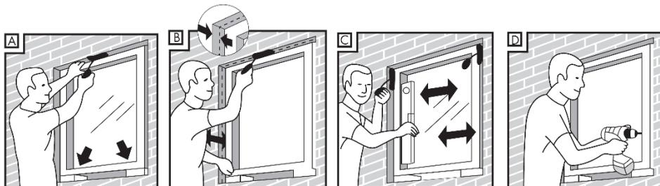
1. Stellen Sie den Fensterrahmen in die Maueröffnung und beachten Sie die korrekte Ausrichtung des Fensterrahmens (Abb. A).
