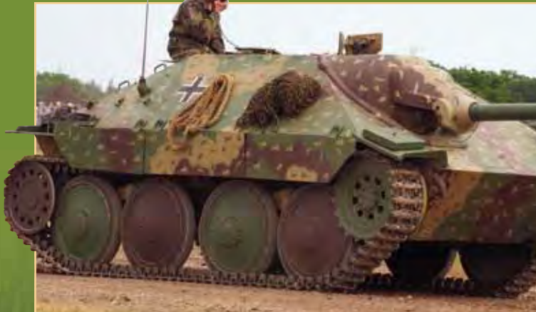
Der Jagdpanzer 38 (t) »Hetzer« wurde auf dem Fahrgestell des PzKpfw 38 (t) gebaut und mit einer 7,5-cm-PaK L/48 bewaffnet.
