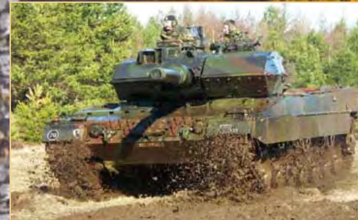
Der Leopard 2 A6 ist in der Lage, mit Hilfe seiner KE-Munition 1000 mm Panzerstahl zu durchschlagen. (Foto: E. Heidtmann, © CC-BY-SA-3.0)
