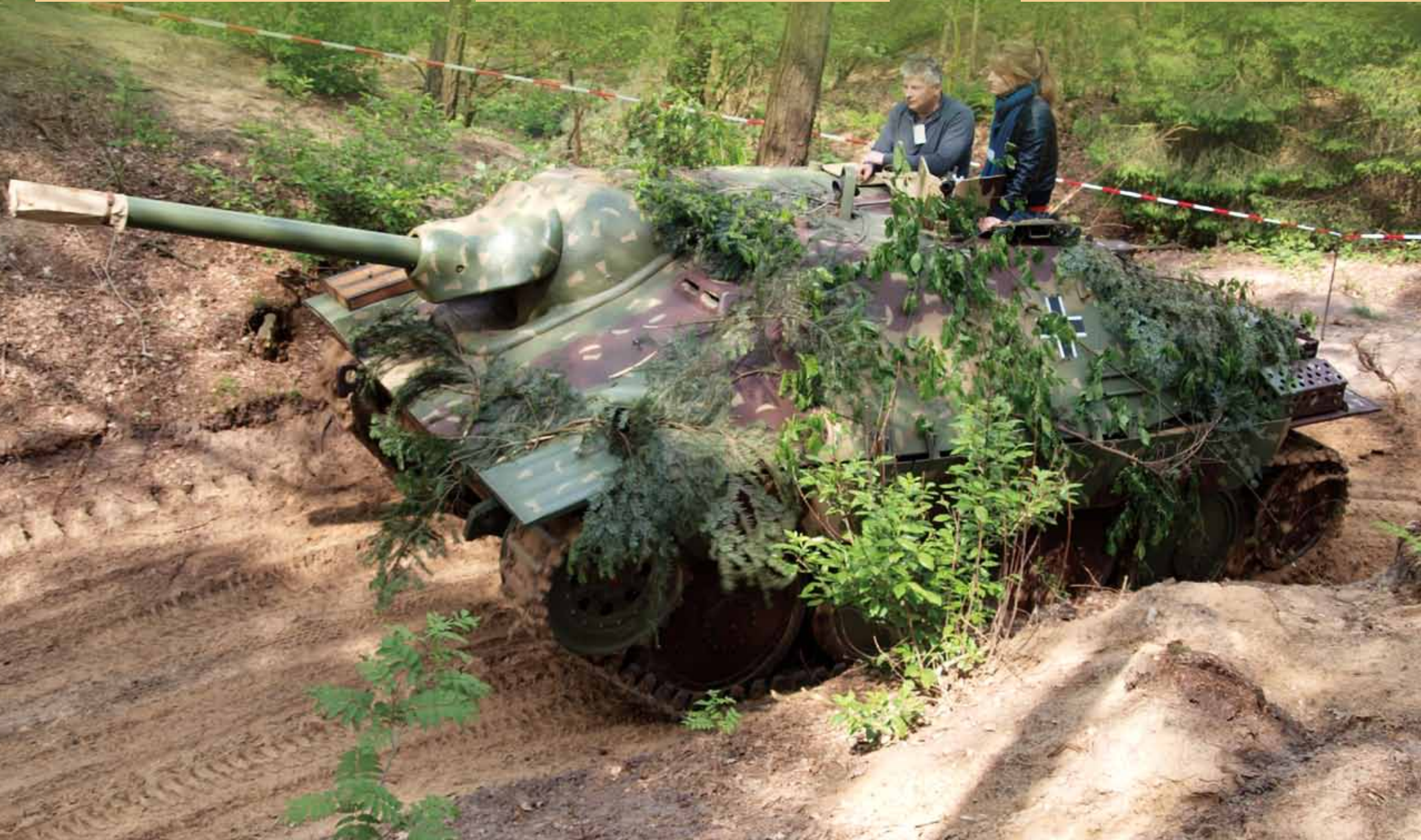
Getarnter Jagdpanzer 38 (t) »Hetzer«. Seine abgeschragten Flächen waren optimal zur Geschossabwendung. (Foto: Alf van Beem, © PD)
