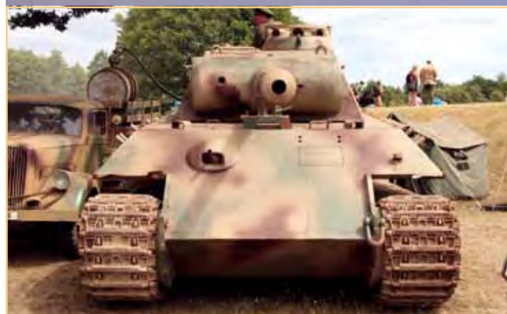
Der Panther wurde von einem 700-PS-Motor angetrieben, der ihm eine Höchstgeschwindigkeit von 46 km/h bescherte. (Foto: Alf van Beem, © PD)
