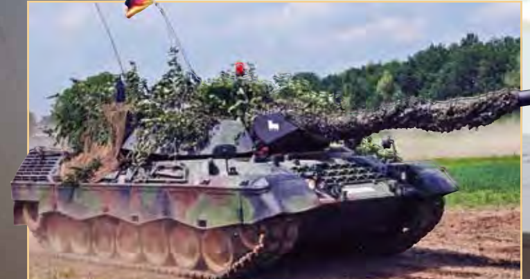
Der Leopard 1A5 wurde ab 1986 u.a. mit einer leistungsfähigeren Feuerleitanlage und einem Laserentfernungsmesser ausgerüstet. (Foto: Rainer Lippert, © CC-BY-SA-4.0)
