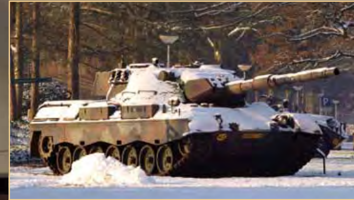
Ein 830-PS-Triebwerk ermöglichte dem Leopard I eine Höchstgeschwindigkeit von 65 km/h. Als Hauptbewaffnung diente die in Lizenz gefertigte britische 105-mm-Zugrohr-BK L7A3 L/51 (Foto: Alf van Beem, © PD)
