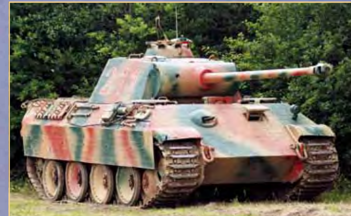
Wie sein Gegner, der T-34, besaß auch der Panther abgeschrägte Flächen, um vor feindlichen Geschossen besser geschützt zu sein. (Foto: Besopha, © CC-BY-SA-2.0)
