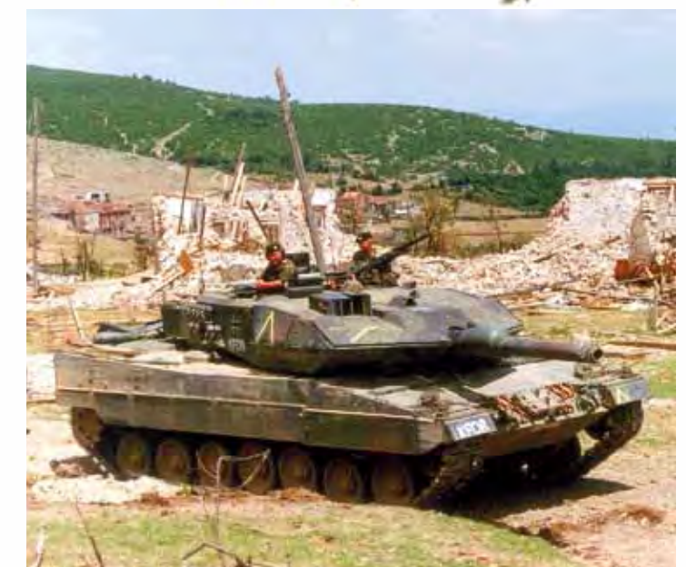
Der Leopard 2A5 mit seiner auffälligen, keilförmigen Panzerung am Turm. (Foto: © KMW)
