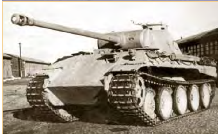
Panther der Ausf. D sind gut an der fehlenden Kugelblende für das Bug-MG sowie der tonnenförmigen Kommandantenkuppel zu erkennen.
