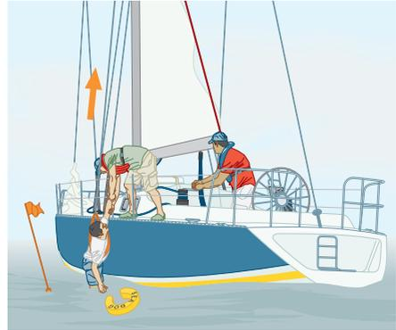
6. Der Skipper nähert sich durch einen Aufschleier in den Wind oder mit Wind querab (besser geeignet) von der Seite her der Person im Wasser. Die Maschine muss gestoppt werden. Legen Sie eine Leine um die Person im Wasser. Bringen Sie die Person über das Heck, die Badeleiter oder auch mit einem über die Winsch gelegten Fall an Bord.
