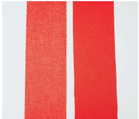
Beim maximal gedehnten Streifen (links) ist die spezielle Gewebestruktur zu erkennen.
