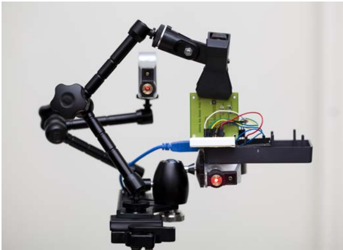
Abb. 1 Der erste finnische Satellit startet 2014. Den Prototyp für den Sonnensensor haben wir mithilfe des Arduino entworfen und gebaut.
