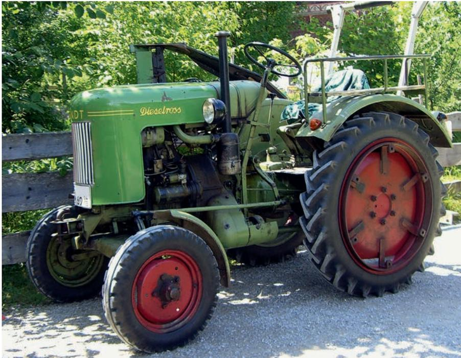
Ebenfalls 1951 stellte Fendt das Dieselross F 15 H 6 vor. Auch dieses Modell hatte eine verbesserte Vorderachse. Das Kürzel „H“ zeigt an, dass es sich hier um einen Hackfruchtschlepper mit größeren Hinterrädern handelte. Die „6“ stand für die hochwertigere Ausstattung mit einem Sechsgang-Getriebe. Das war auch für den Typ G erhältlich.
