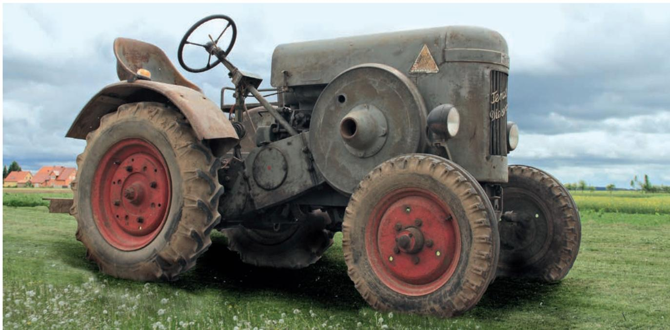
Der F 18 wurde nach dem Zweiten Weltkrieg wieder produziert. Allerdings gab es eine entscheidende Veränderung: Der Traktor erhielt nun eine schicke Motorhaube, die noch längere Zeit das Bild der Dieselrösser von Fendt prägte. Wie schon das Vorkriegsmodell besaß dieser F 18 ein Viergang-Getriebe.
