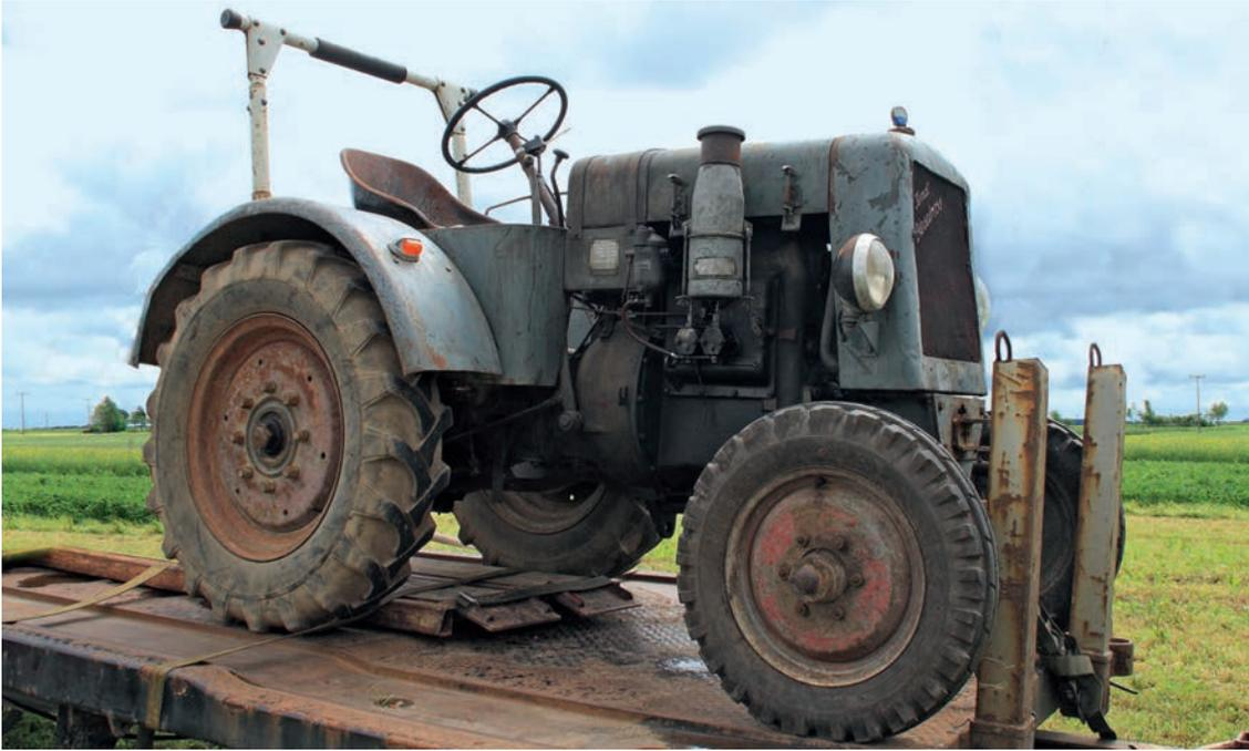
Der 1938 vorgestellte F 22 war der erste Fendt-Schlepper mit Motorhaube und der erste mit einem Zweizylinder-Motor. Verwendet wurde das Aggregat F2M 414 von Deutz, das in den 22-PS-Modellen vieler anderer Hersteller ebenfalls zur Verwendung kam.
