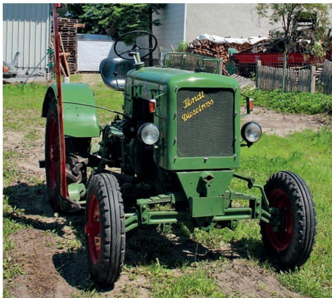
Mit dem F 22 hatte Fendt erstmals die rahmenlose Blockbauweise zur konstruktiven Grundlage genommen. Das machte den Schlepper leichter und billiger. Erstmals war man auch von der Verdampferkühlung abgegangen. Der F 22 musste wegen der Kriegslage eingestellt werden, kam aber – wie das abgebildete Modell – nach dem Krieg noch einmal in den Verkauf.
