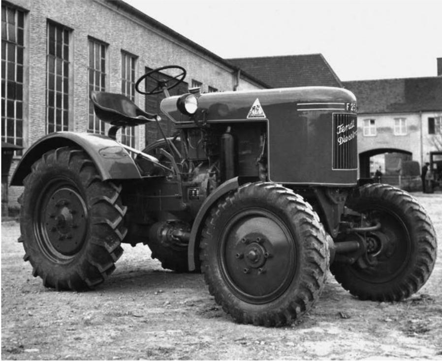
**Einsatz:** 1951 brachte Fendt mit dem F 18 H eine verbesserte Version des Nachkriegs-F-18 an. Für den Mähantrieb war das Konzept überdacht worden. Er erfolgte nun direkt vom Motor, damit konnte das Mähmesser bei verschiedenen Fahrgeschwindigkeiten auf beliebige Drehzahlen gebracht werden. Viele Landwirte schätzten diese Eigenschaft besonders bei altem und liegendem Gras.
