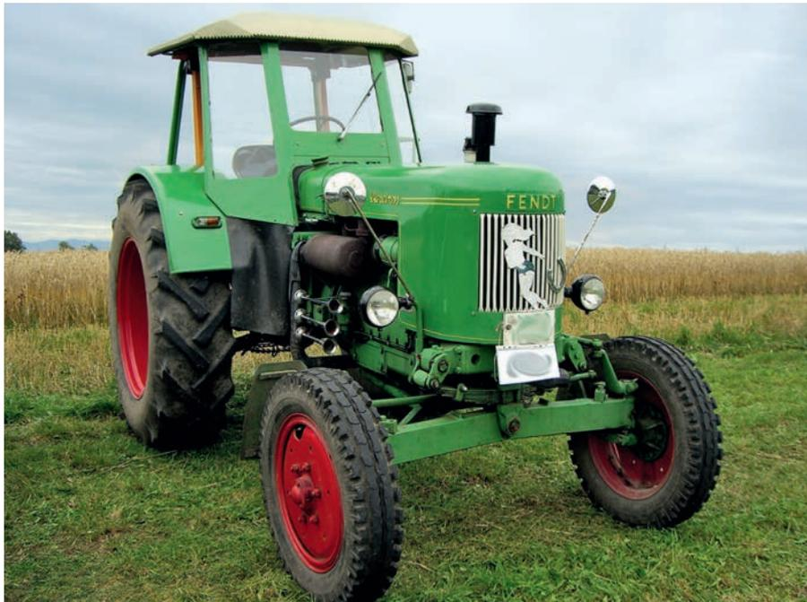
Mit dem 40-PS-Dieselross F 40 U wagte sich Fendt erstmals ins Revier der Großschlepper vor. Der ab 1951 gebaute Dreizylinder-Traktor konnte für den Einsatz im Transportgewerbe auch mit einer Druckluftbremsanlage ausgestattet zur Auslieferung kommen. Der F 40 U war der Vorläufer des berühmten Favorit 1.
