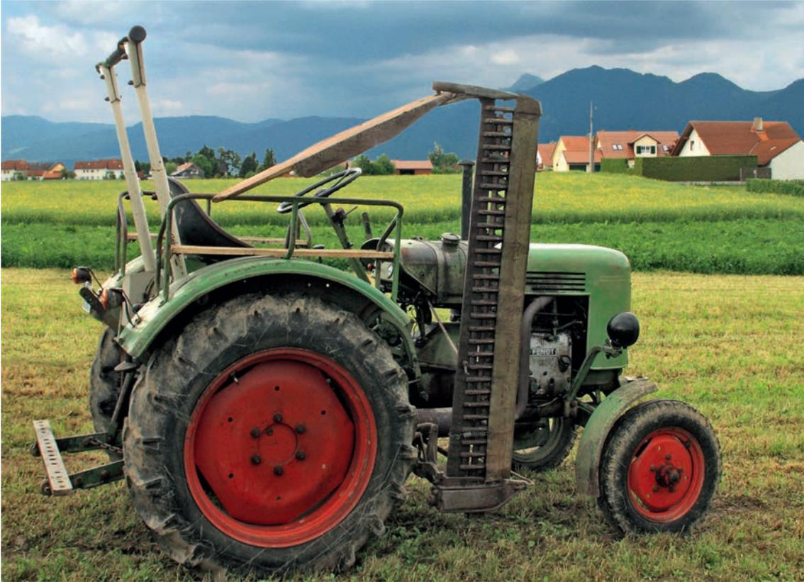
1954 führte Fendt einen modernen Zweizylinder-Schlepper mit luftgekühltem MWM-Motor ein: den F 24 L. Fendt hatte sehr schnell auf die Herausforderung durch Deutz und Eicher reagiert und bot die meisten neuen Modelle in zwei Versionen an – mit luftgekühltem oder mit wassergekühltem Motor.
