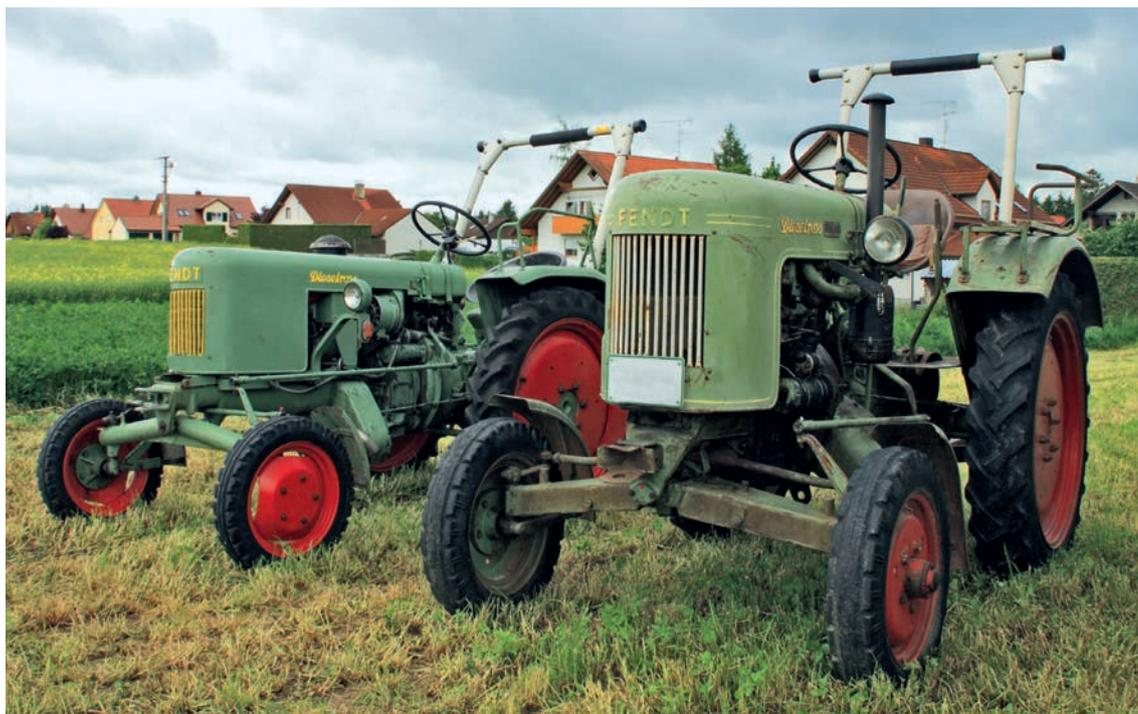
**Zwei echte Gegensätze und doch beides Dieselrösser: Der F 12 HL ist ein luftgekühlter Einzylinderschlepper, der F 24 W rechts ist ein wassergekühlter Zweizylinderschlepper. Beide stammen aus den Jahren um 1956.**
