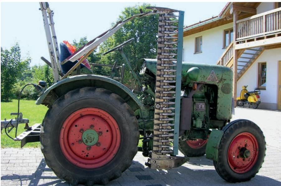
Ab 1951 boten die Marktoberdorfer eine verbesserte Version des F 15 an, die die Bezeichnung F 15 G trug. Wichtigste Änderungen waren eine verstärkte Vorderachse und staubdicht verkapselte Vorderradnaben.
