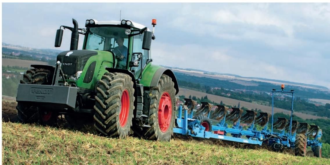
**Der Fendt 939 Vario ist das neueste Flaggschiff der Schlepper aus Marktoberdorf. Der neue Kraftprotz im grünen Lack verfügt über 360 PS Nennleistung. Dank des Vario-Getriebes lässt er sich stufenlos bis 60 km/h beschleunigen.**
