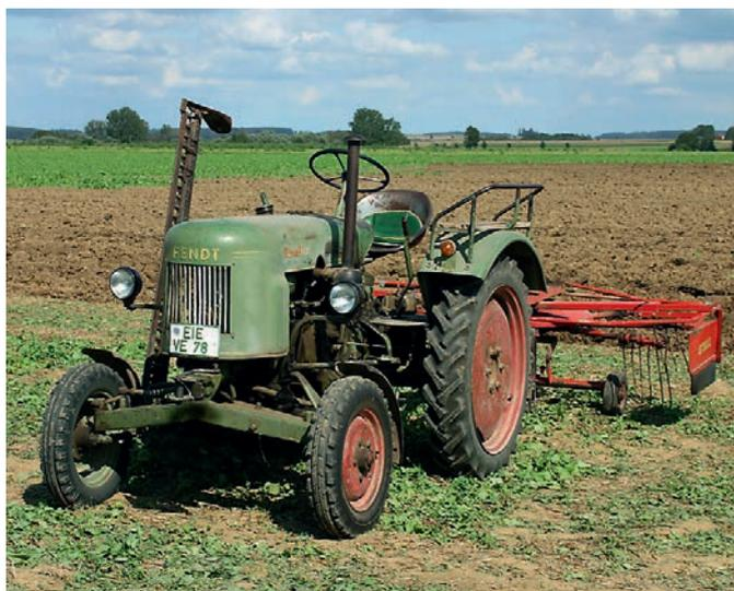
**Das Dieselross F 17 wurde zwischen 1956 und 1959 sowohl mit luftgekühltem als auch mit wassergekühltem Motor gebaut. Dieses Zweizylinder-Modell war für kleinere Betriebe bestimmt, die einen universal einsetzbaren und nicht zu teuren Schlepper suchten. Zum Lieferumfang gehörte auch ein Dreipunkt-Kraftheber.**
