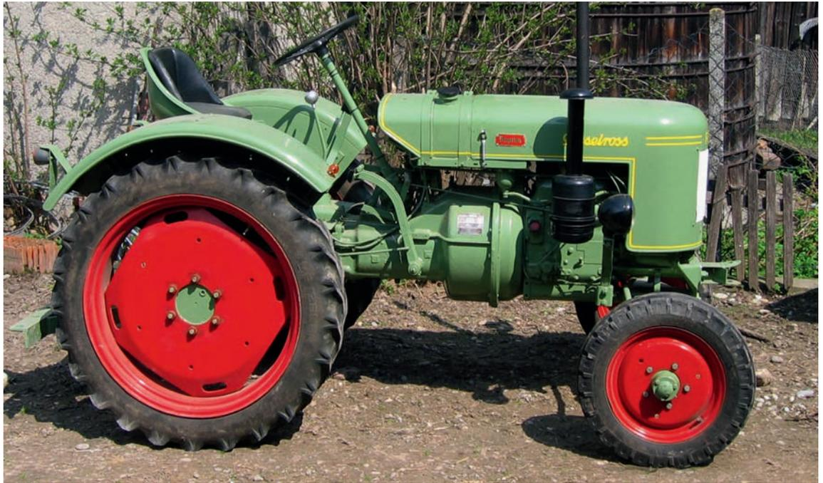
**Varianten:** Ein Jahr nach dem F 24 L zog Fendt mit einer Variante nach, die einen wassergekühlten Motor besaß. Der war allerdings weniger modern und arbeitete noch nach dem Wirbelkammerverfahren. Der Hubraum war auch etwas kleiner als der des luftgekühlten Bruders, die PS-Leistung erwies sich jedoch als identisch. Fendt hatte mit dem F 24 einen leistungsfähigen Traktortyp geschaffen.
