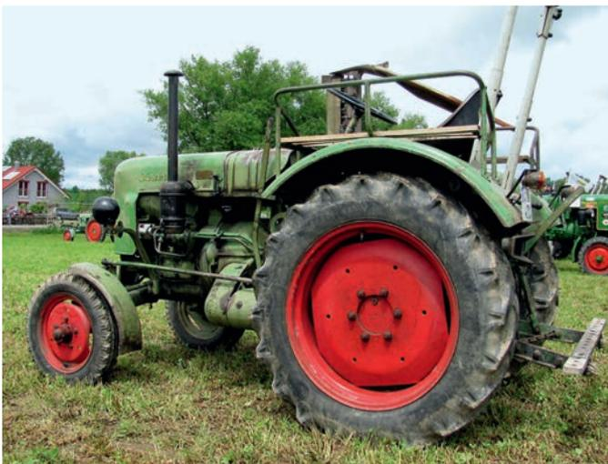
Der F 24 L besaß ein Sechsgang-Getriebe aus eigener Fertigung und eine fußbetätigte Differenzialsperre. Ein hydraulischer Kraftheber und die Dreipunktaufhängung gehörten ebenso zur Ausstattung wie die Möglichkeit, einen Frontlader anbauen zu lassen.
